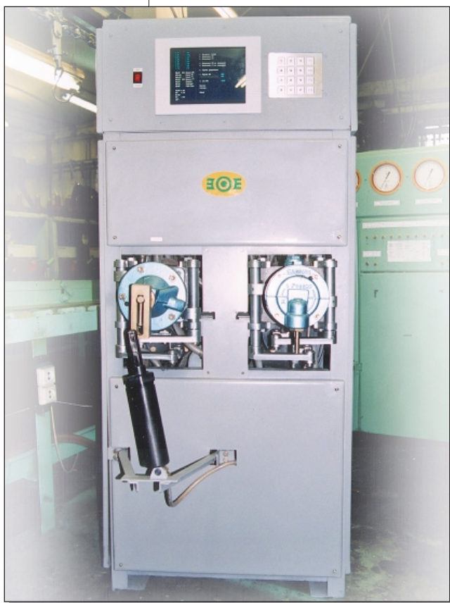
Автоматический электронно-пневматический стенд проверки воздухораспределителей типа № 483
